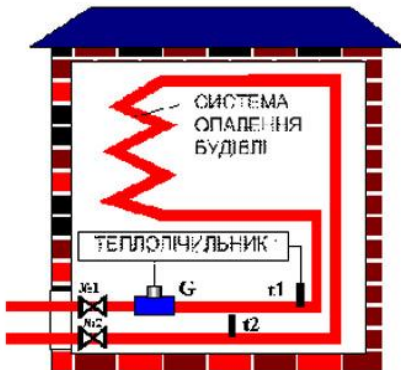
Рис. 4.2. Система опалення будівлі
